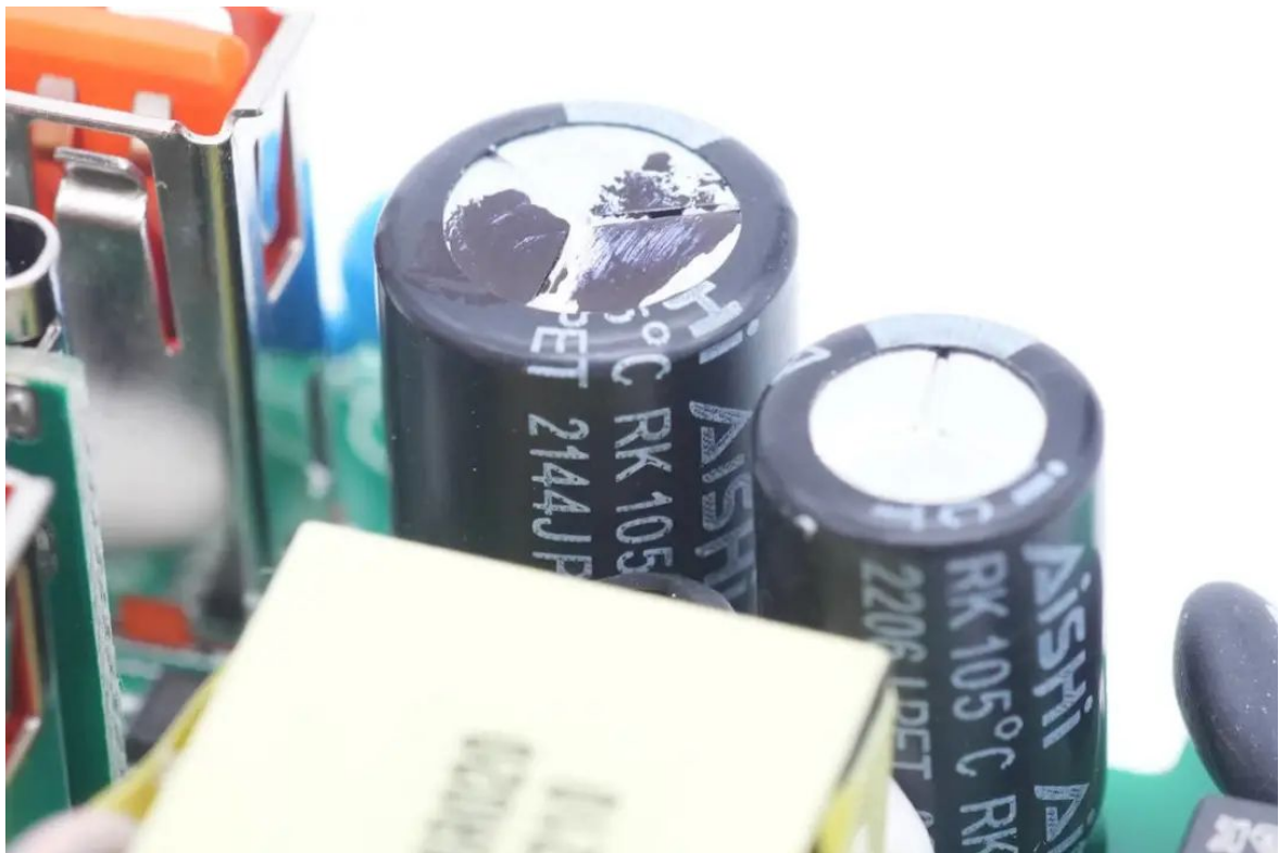
两颗滤波电解电容均来自AiShi艾华，RK系列105°C耐热。
