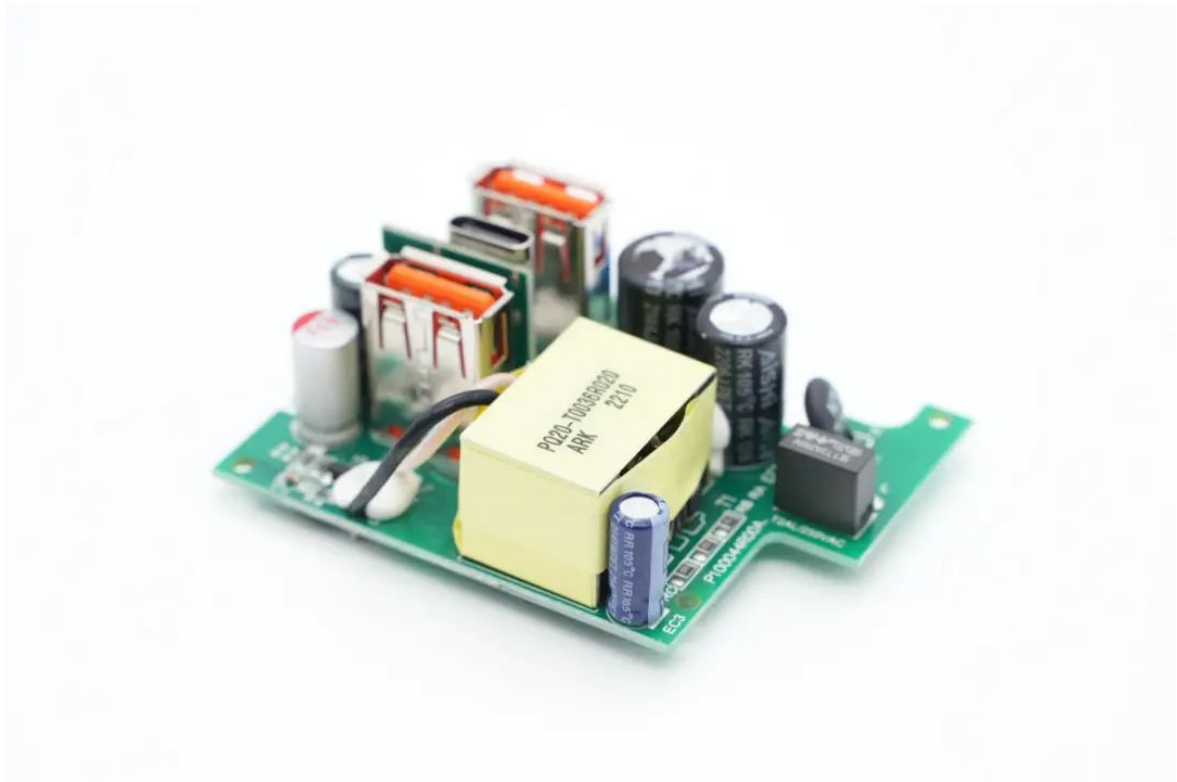
快充模块输入端一览，焊接保险丝和NTC浪涌抑制电阻。
